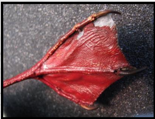
Teixit no teixit de polièster “Remay”® adherit amb Paraloid® B72 al 10% Acetona.
