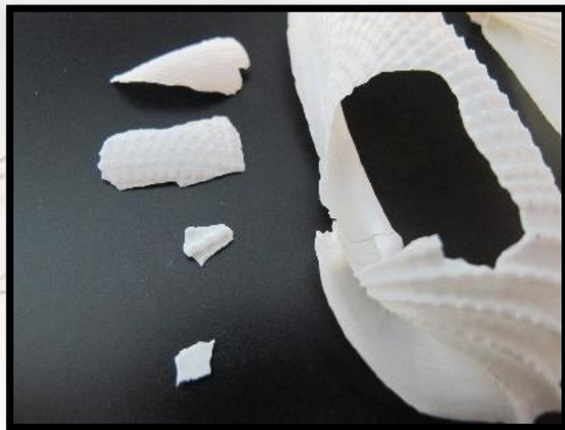
Resina Acrílica. Paraloid® B72 al 20% Acetona. Amb pinzell.
